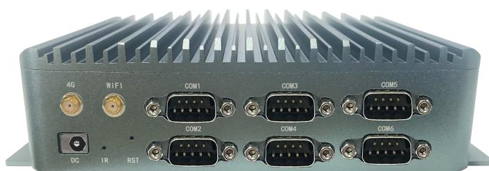
AIM-3588 工控机采用瑞芯微 RK3588 八核 64 位 ARM 处理器，其配置为 4\*Cortex-A76 + 4\*Cortex-A55 CPU，主频最高 2.4GHz，集成 Mali-G610 MP4 四核 GPU，内置 6Tops 算力 NPU，三核架构，支持 INT4/INT8/INT16 混合运算；可支持 Android 或 Linux 操作系统；支持 8K@60Hz HDMI 输出。
